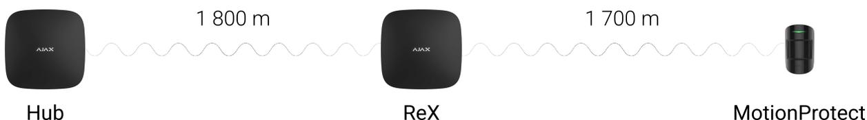
Die maximale Reichweite der Funkverbindung mit angeschlossenen Geräten beträgt 1.700 Meter ohne Hindernisse. Es können bis zu 5 Funk-Repeater an das Ajax-Sicherheitssystem angeschlossen werden. Es ermöglicht die Verwendung von Ajax-Produkten zum Schutz von Großanlagen. Unabhängig von der Anzahl der an ReX angeschlossenen Geräte werden die Alarmer innerhalb von 0,3 Sekunden übermittelt.
