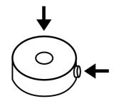
Zwei Montagemöglichkeiten der Kabelverschraubung: oben oder seitlich
