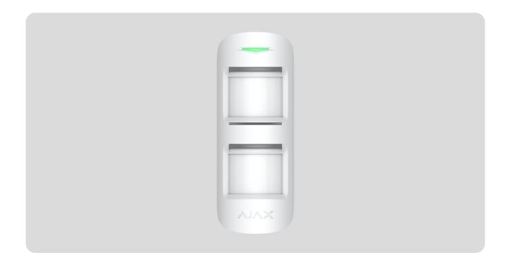
**MotionProtect Outdoor Jeweller** ist ein kabelloser Bewegungsmelder für den Außenbereich. Die Reichweite der Bewegungserfassung ist einstellbar und kann bis zu 15 Meter erreichen. Der Melder verfügt über ein Anti-Masking-System, das Versuche erkennt, die Sicht des Geräts zu behindern. Bei richtiger Montage und Einstellung reagiert der Melder nicht auf Tiere bis zu einer Größe von 80 cm.
